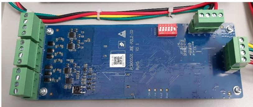
3. Fijar la tarjeta, usando los 4 tornillos proporcionados.
