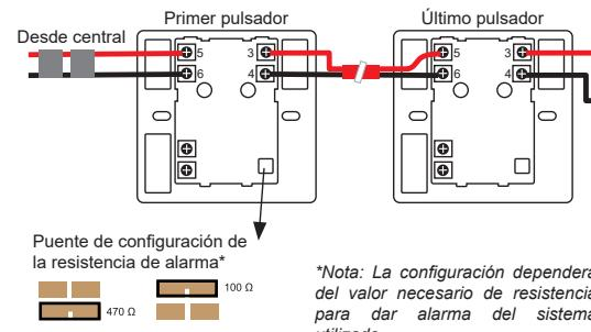
\*Nota: La configuración dependerá del valor necesario de resistencia para dar alarma del sistema utilizado.
