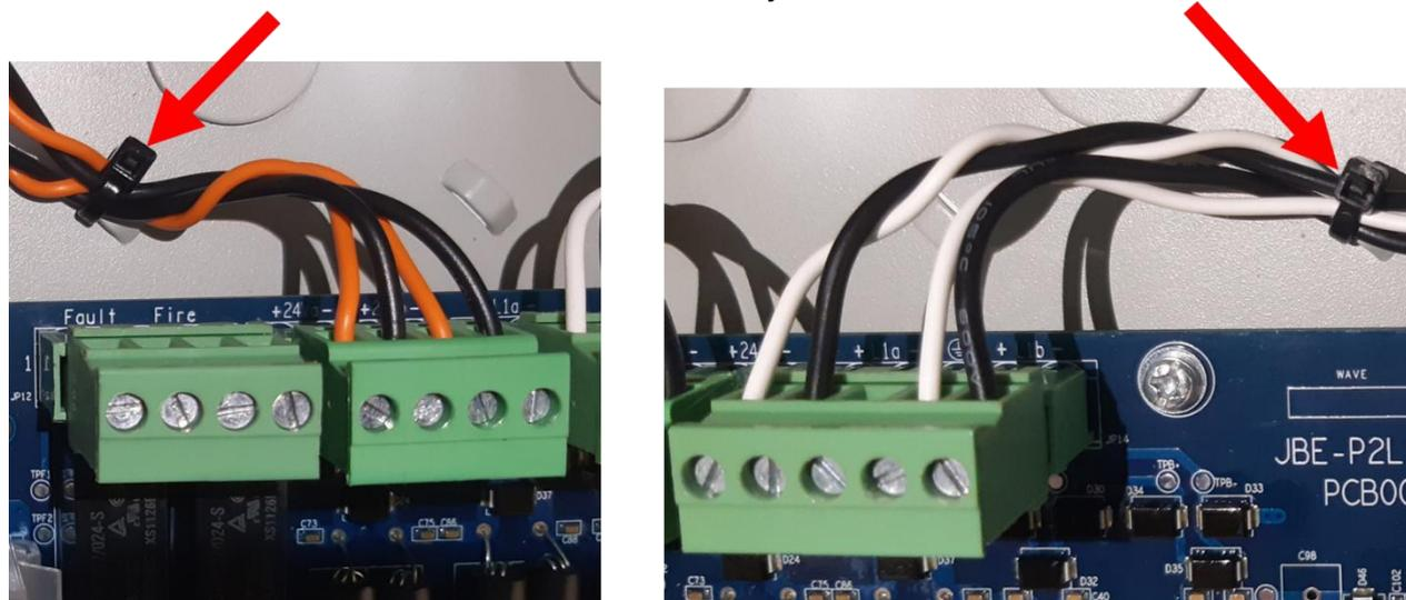
Figura6: Ilustração de cablagem segura
