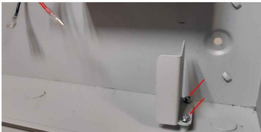
Figura 7: Soportes de soporte de batería
